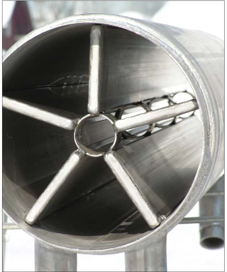
Dieser Wärmetauscher nutzt die Energie einer Stückholzfeuerung.
